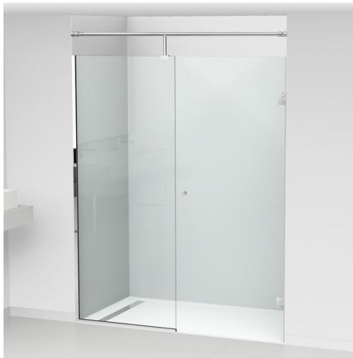
Panneau fixe en verre sécurit transparent 8 mm monté sur 3 profilés en aluminium poli ou poli brillant 20 x 16 x 20 mm. Porte pivotante montée sur 2 charnières QUADRA en laiton massif chromé brillant fixées sur le mur. Poignée de porte double en laiton massif chromé brillant. Tendeur tringle en inox poli brillant. Joints d'étanchéité en PVC translucide. Joint de seuil double lèvre avec lèche-goutte. Joint vertical côté charnières à bourrelet. Joint de fermeture à blocage. Visserie inox fournie.
